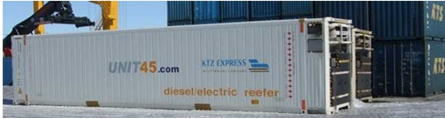
図表 6-27 KTZ-E の保有するエンジン付きリーファコンテナ (45ft HC)
