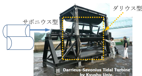
図 5.1.4 九州大学の実海域実験（ダリウス・サボニウス混合水車） （出典：経塚雄策、2014による図を一部改変）
