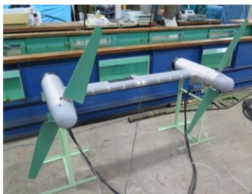
図 5.2.7 水中浮遊式双発海流発電施設の模型外形 (出典：海上・港湾・航空技術研究所海上技術安全研究所提供)
