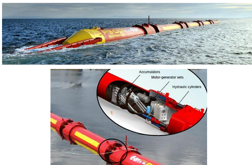
図 4.1.31 Pelamis P2 の全体 (上) および油圧発電機構 (下) (出典 : Pelamis Wave Power ウェブサイト)
