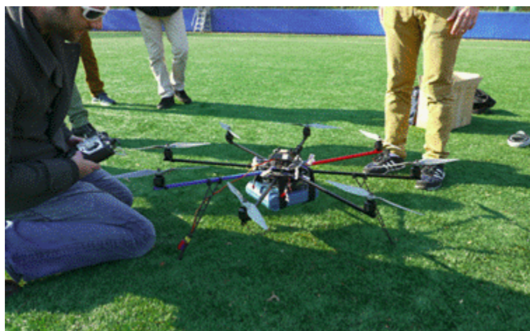
図 2-13 AED 搬送の飛行試験に使用する無人航空機
