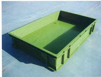
②【定時測定】 純水を5リットル入れ、24時間採取 【月間測定】 純水を5リットル入れ、1ヶ月間採取
