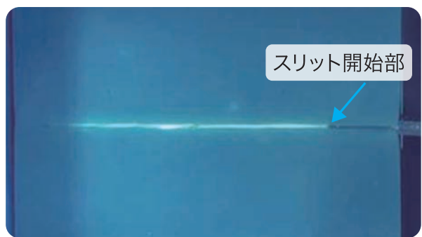
[自社実験]: 青色の色素を含んだスポンジにスリット型ドレーンを配置しておき、吸引をかける。
