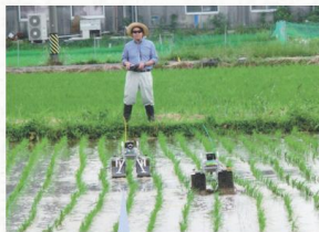
全長50cm×幅45cm×高さ50cmで、ボディはアルミ製。幅広いキャタビラで田んぼをかき混ぜる
