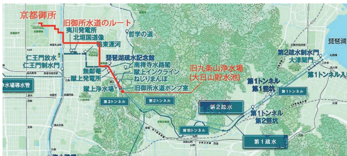
図1 琵琶湖疏水と旧御所水道（京都市上下水道局資料・赤色部分を筆者加筆）
