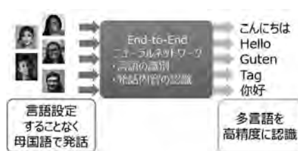
図7 多数のユーザーが何語を話すか分からない状況でも認識
