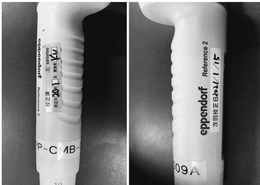
図 12. ピペットに貼り付けた校正日と次回校正日
