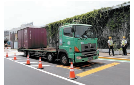
試験中のトラックスケール
