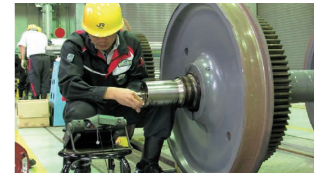
車軸の超音波探傷実習(非破壊検査担当者研修)
