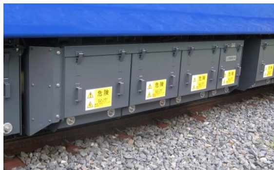
非常走行用電源装置の搭載イメージ (写真はEV-E801系の主回路用蓄電池装置)
