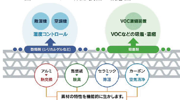
図1：ハニカム成形技術の概念図
