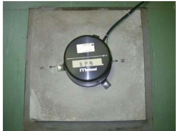
センサーおよび設置台 外観に異常は見られず、水平状況にも異常はなかった。
