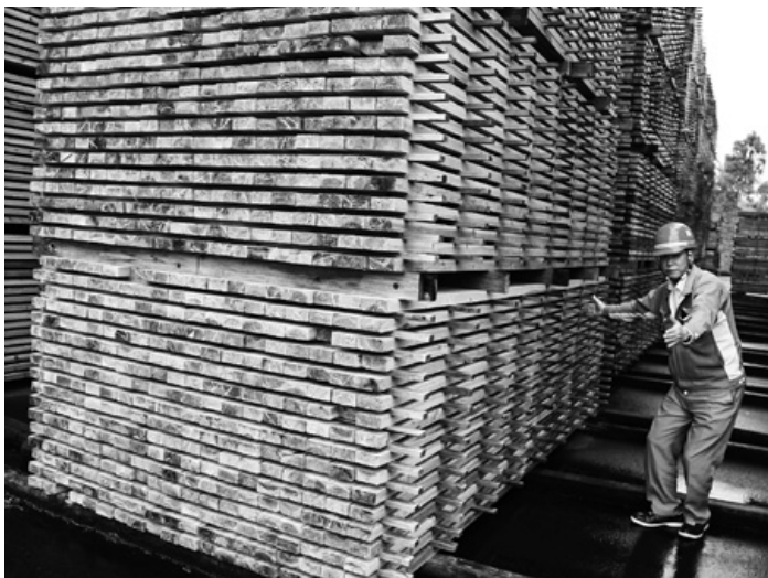
上:外材製品の在庫があふれる15号地木材埠頭 下:ツーバイフォー住宅用のスギスタッド(間柱)の天然乾燥(株式会社さつまファインウッド)
