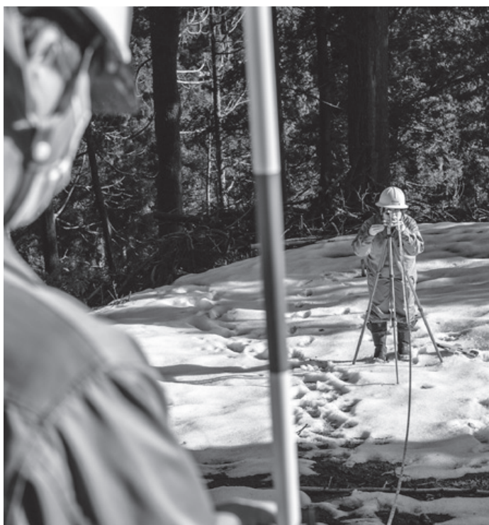
生えている木の高さを測ったり、隣の森林との境界を確認したりして手入れする森林の現状を確かめ、作業計画を作成する(左・右上) 作業完了後伐った木の太さを測り、再び森林の状態を確認。森林所有者や行政への報告書をつくる(右下)
