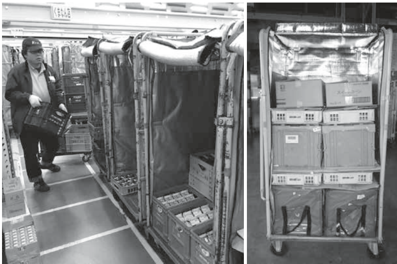
冷凍、冷蔵、常温の荷物を「カゴ車」に積む
