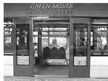
5000系の出入口 段差はほとんど無し
