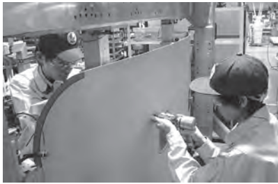
二人で作業する航空機部品のリベット打ち
