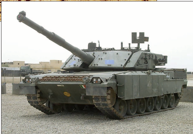
Un Ariete dotato della corazzatura spaziale impiegata in Iraq nel 2004.
