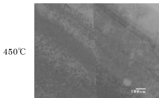
図 3-30 温度 450°Cにおけるイオン照射後の結晶粒微細化 0.06C0.6Ti 材観察写真
