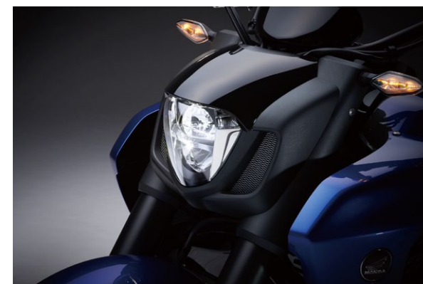
ヘッドライトをはじめとして、灯火器にはLEDを全面適用
