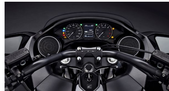
様々な情報を確認できるTFT液晶パネル
