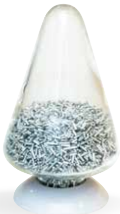
メソポーラスシリカに封入された プラチナ触媒 (ガラス容器内)。
