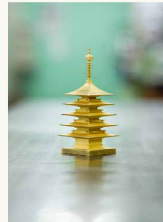
試作ソリューション部門の機械工作で、ワイヤ放電加工機によりサンプルとして真鍮の塊から切り出して作った高さ5cmほどの五重塔。芸術的ともいえる。
