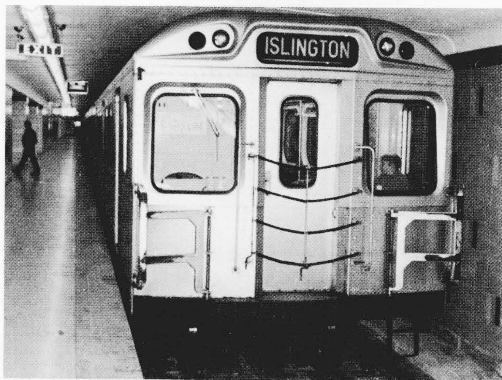
図1 トロント市地下鉄電車 8個の主電動機を制御するチョッパ制御装置がこれらの電車の床下に取り付けられている。
