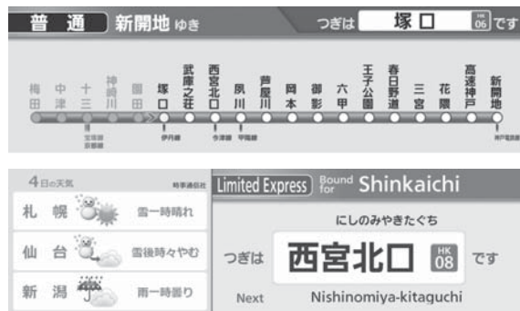
図7. 車内案内表示器の画面例 — 駅数の多い路線図のスクロール表示や、画面分割による2画面同時表示などが可能である。
