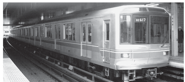
図1. 02系電車 — 02系の車両に、DC架線600 Vを電源とするPMSM主回路システムが搭載されることになった。
