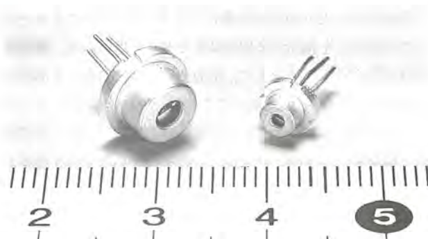
780nm, 50mW ODD 用半導体レーザー
