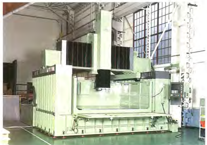
三菱超大型形彫り放電加工機 M300K
