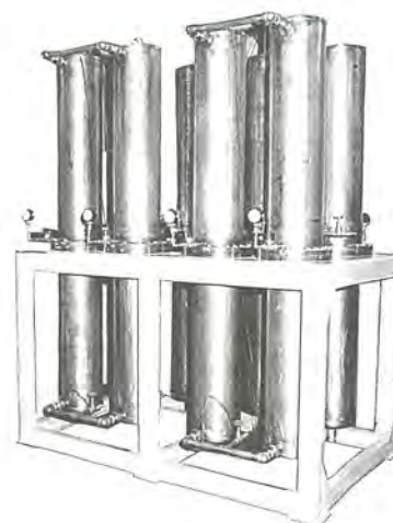
ケミカルヒートポンプ
