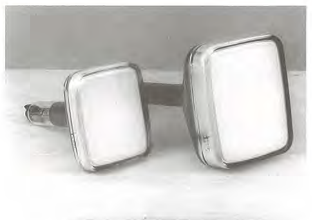
新開発5.5型投写管(左)と7型従来管(右)
