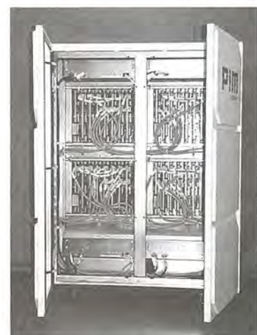
並列推論マシンPIMの筐体(推論プロセッサ32台を収容)
