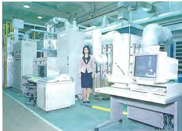
30kW級間接内部改質電池の試験風景
