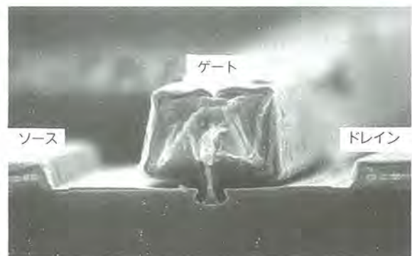
MGF4318D/MGF4918Dのゲート電極断面
