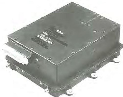
インテルサットⅦ搭載用10W/16W 固体電力増幅器
