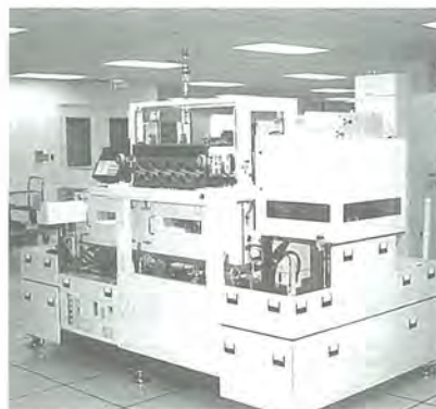
超低温テスト自動化装置
