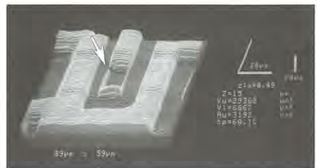
LSIのチップ裏面から観察した接合部の欠陥
