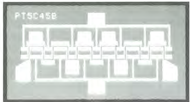
移動体通信用 SAW フィルタ
