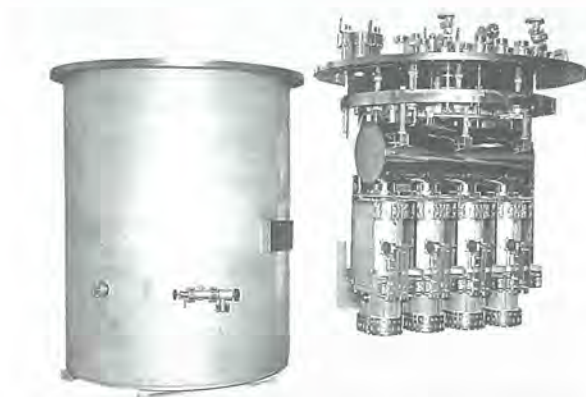
超電導ライナックユニット(クライオスタットと超電導空洞4台)
