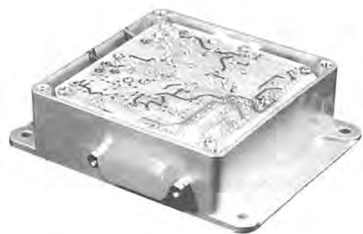
衛星搭載中継器用 DC/DC コンバータ
