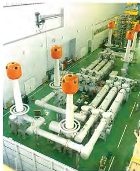
新形550kV GIS送電線ユニット(工場試験形態)
