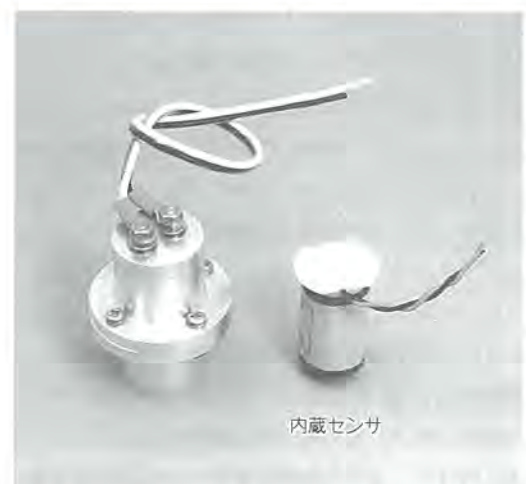
\text{SF}_6 ガス漏れセンサの外観
