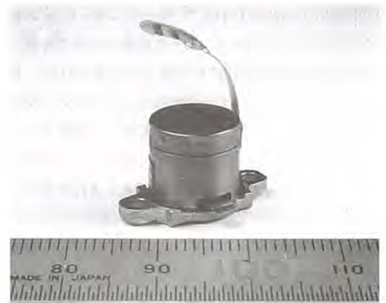
磁気ヘッド可動用小型アクチュエータ
