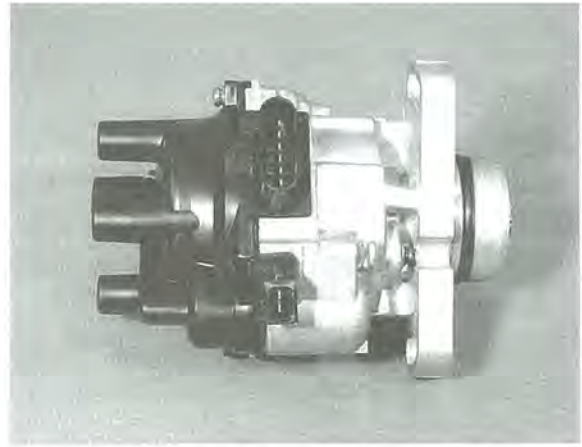
ホール式クランク角センサ内蔵ディストリビュータ
