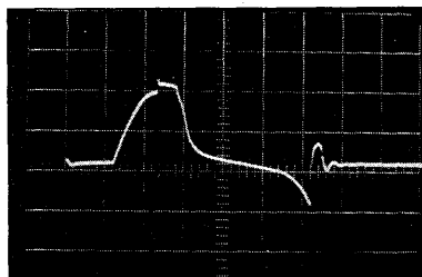
(k) 可飽和リアクトル電圧波形 200V/cm, 100 μsec/cm
