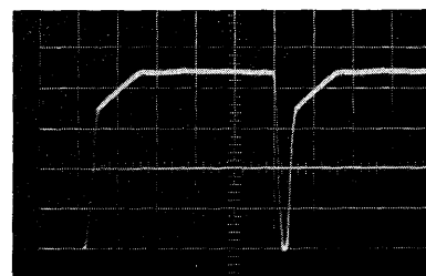
(p) クランプダイオード電圧波形 250V/cm, 1 msec/cm
