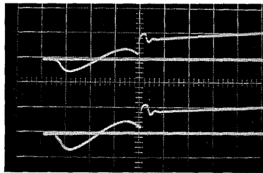
(b) 主サイリスタ転流時電圧波形 200V/cm, 100 μsec/cm
