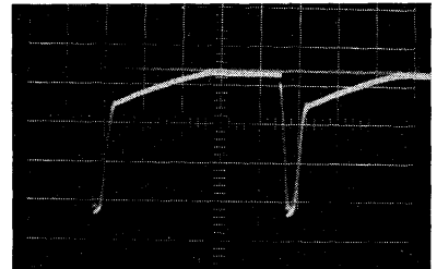
(f) 転流コンデンサ電圧波形 200V/cm, 1 msec/cm
