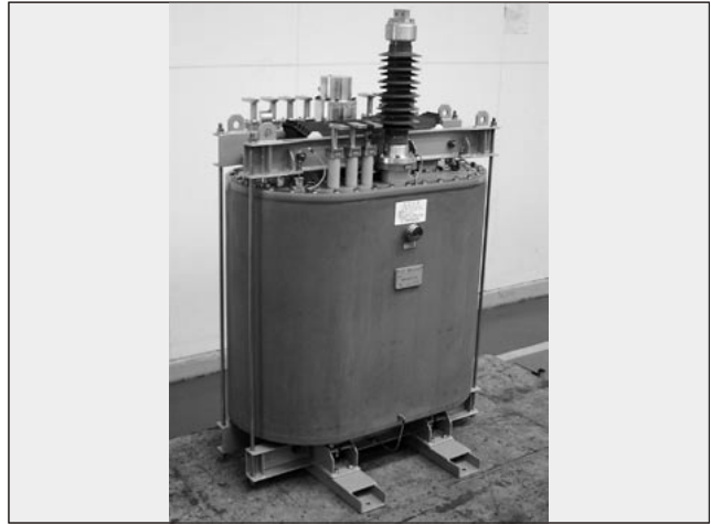
図31 車両用超電導主変圧器
