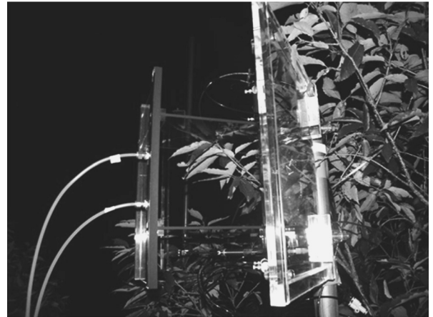
図-2 野外で成木の光合成速度を測定する葉群チャンバー
