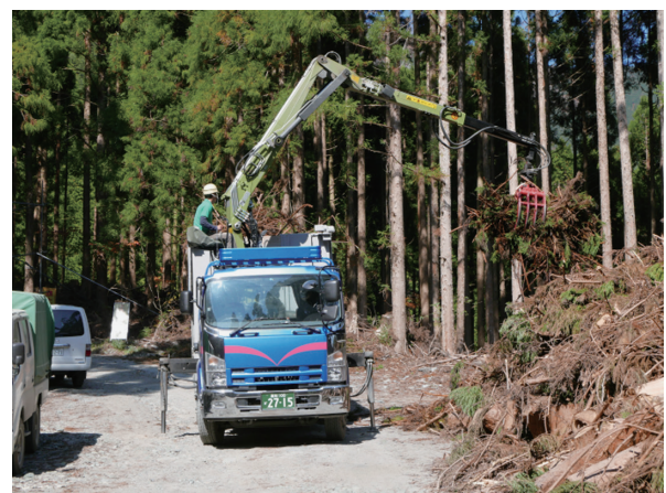
図-2 林地残材のトラックへの積み込み作業 発電所へ輸送するために、林道端に集められた林地残材をトラックのコンテナへ積み込んでいく (高知県 2015 年、JSPS 科研費 15H04508 による調査)。
