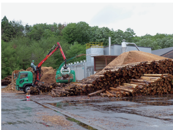
図-1 未利用木材 (丸太) の粉碎作業 製材工場の敷地内に建設中のバイオマス発電所の稼働開始に備え、周辺森林から調達した間伐材を粉碎している (栃木県 2014 年、JSPS 科研費 24580213 による調査)。
