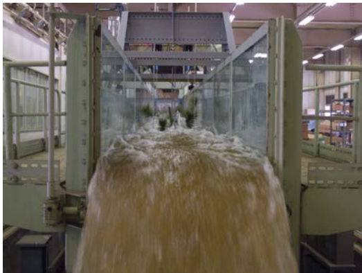
写真6 水流に対する樹木の抵抗特性を知るための水路実験
