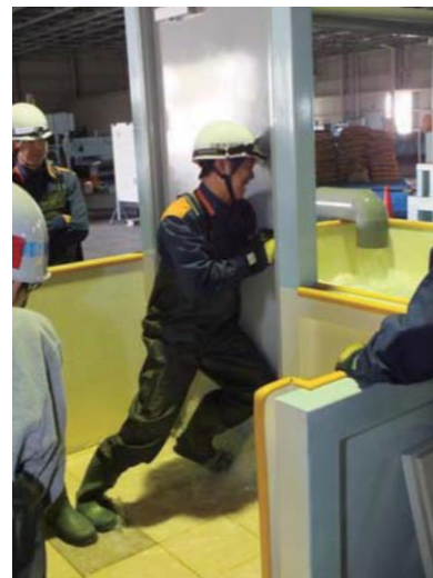
写真 浸水体験実験装置（ドア模型）
