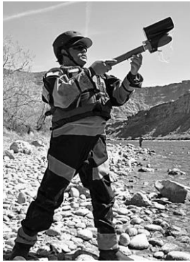
図：EZ ライナーラインランチャーは上向きに 30 度の角度に配置される。
