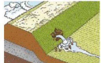
図序-10 漏水（出典：国土交通省HP）
