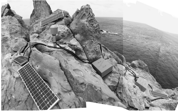
図 7. a) 観測点の全景. 左奥に子安根, 右手に三宅島が見える. b) 図 7a のスケッチ. a~d: ソーラーパネル. e: 計測機器収納箱. f: バッテリー収納箱. g: GNSS アンテナ. h: 地震計. i: LS-8800 用 GPS アンテナ. j: L-03D 用外部アンテナ.
