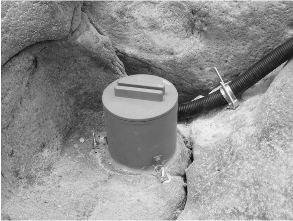
図 5. 設置された地震計。塩化ビニル製カバーの中に LE-3Dlite が設置されている。カバーの大きさは、外径 125mm、高さ 133mm。
