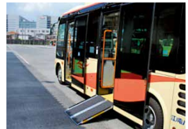
車椅子用スロープ
