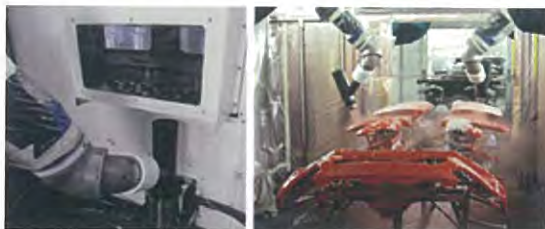
塗装ロボットに塗料カートリッジを採用(コペンファクトリー)
