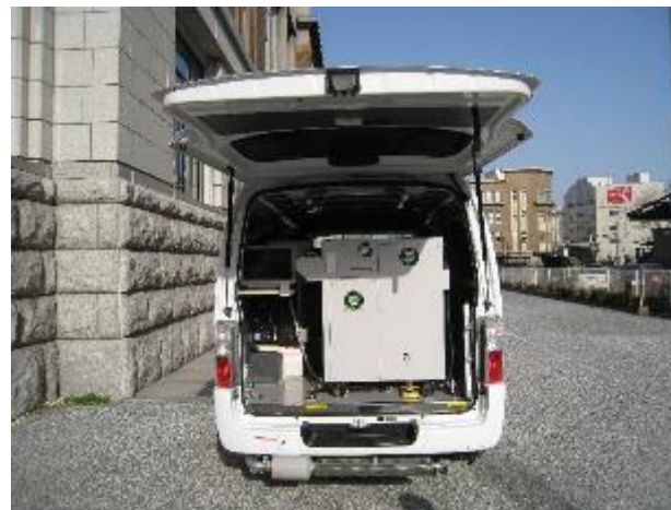
平 21.3 爆発物車載型探知装置の導入 貨物の表面等に付着している粒子を拭き取り、採取した物質を解析することにより、不正薬物・爆発物の痕跡の有無を確認する装置。
