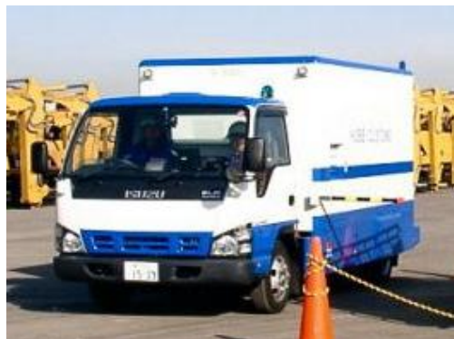
平 19.3 車載式後方散乱エックス線検査装置の導入 従来の透過型の X線検査装置と異なり、X線を貨物に向かって照射し、対象貨物の横を低速で通り過ぎるだけで検査ができる。
