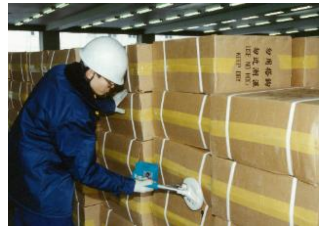
金属探知機による検査状況 電磁誘導を利用して金属の有無を探知する機器であり輸出入貨物検査等で使用している。
