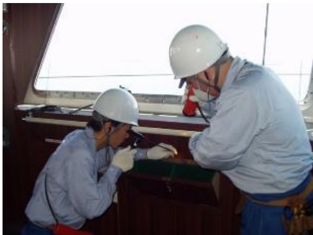
ファイバースコープの検査状況 船内検査や輸出入貨物検査で直接目視できない奥まった狭小な場所を確認する時に使用している。
