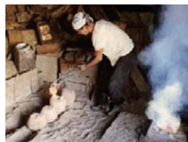
型に銅合金を注入する作業
