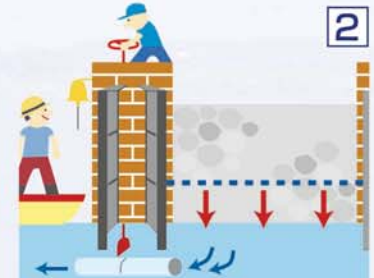
2 係員が給水溝を開き、閘門内の水位を船側の水位と同じにします。
