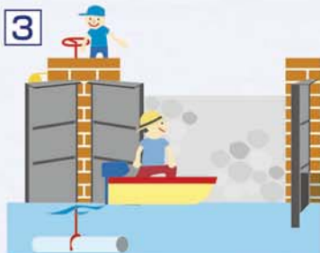
3 給水溝を閉めてから水門が開けられ、船がゆっくりと閘門内に入ります。
