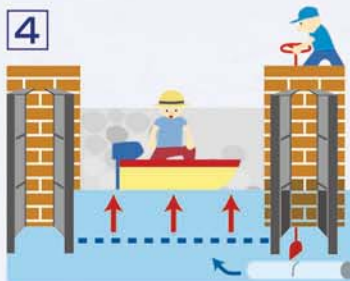
4 水門が閉められ、もう一方の給水溝を開き、閘門内の水位を船の行先側の水位に合わせます。
