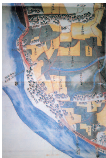
写真(3) 河畔砂丘を利用した連続堤 砂山長三百五拾間（神明津村絵図、天保12年）
