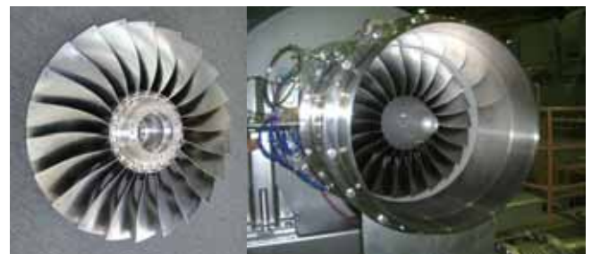
図3 ファン翼型（左）とファン試験機
