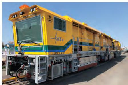
レールの表面を削るレール削正車
