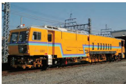
道床をつき固めるマルチブルタイタンバー
