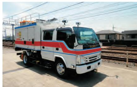
架台を格納した電気検測車
