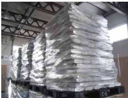
溶解・圧縮した発泡スチロールのインゴット
