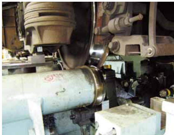
車輪の削正状況
