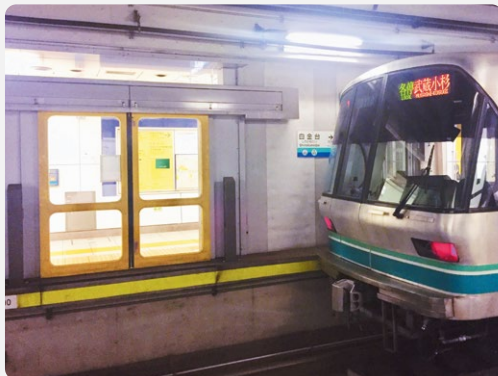
▲手前のホームドアは現在未使用 8両編成化に伴い改修予定
