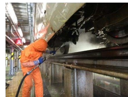
函館新幹線総合車両所での車両融雪作業
