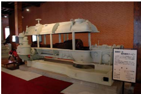
【国産陸用蒸気タービン （三菱重工㈱長崎造船所史料館収蔵）】 （長崎県長崎市）
