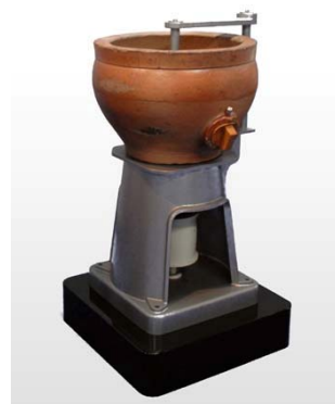
【(株)サタケ 日本で初めて開発された酒造用研削式精米機 (明治41年式第2佐竹精穀機)】 (広島県東広島市)
