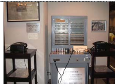
【磁石式手動交換機（門司電気通信レトロ館所蔵） （福岡県北九州市門司区）
