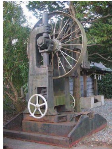
【クラーク・ブラザーズ型 帯鋸盤 (米国クラーク・ブラザーズ社製) (㈱富士製作所 所蔵)】 (静岡県沼津市)
