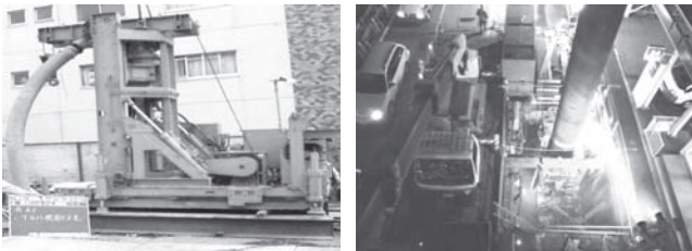
写真—5 場所打ち杭（RCD工法） 写真—6 鋼管杭（油圧式中掘り工法）
