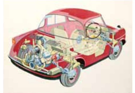
③リアエンジンであることが容易に見て取れる。ブレーキはアルフィン社製ドラム式(油圧内部拡張式4輪制動)。サスペンションはフロント、リアともにトレーリングアーム方式の全輪独立懸架。
