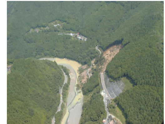
約120mにわたって崩落した国道168号
