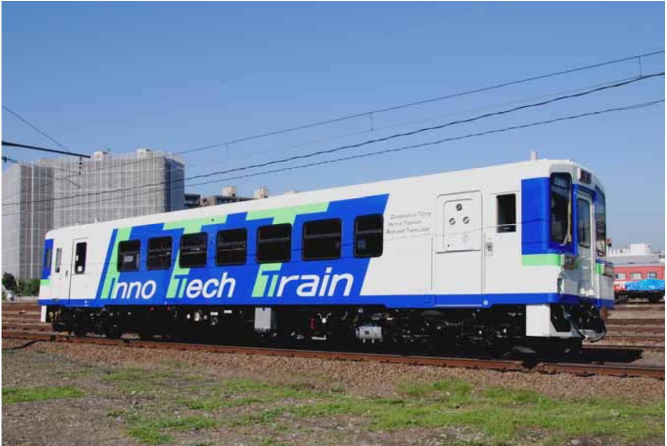
写真:モータ・アシスト式ハイブリッド駆動システムを搭載したITT(Innovative Technology Train)
