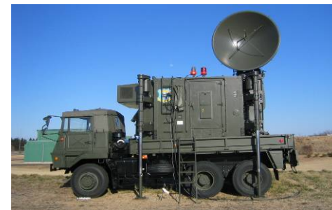
〈移動式気象レーダ装置J/TPH-701〉
