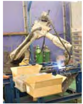
▲CO2 ロボット溶接加工
