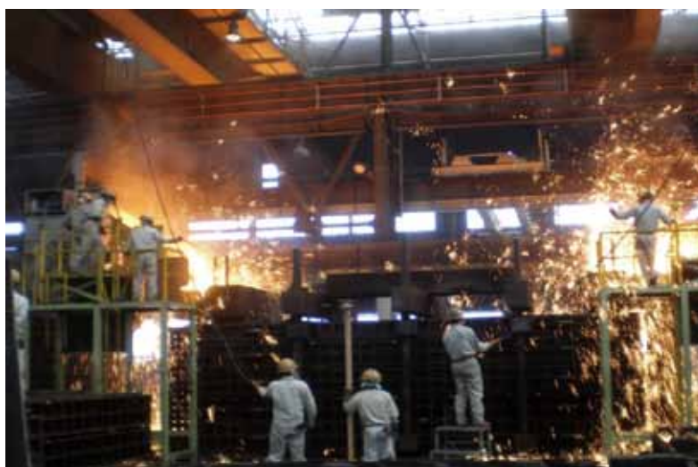
▲溶かした鉄(約1400°)を両端から型に流し込む工程
