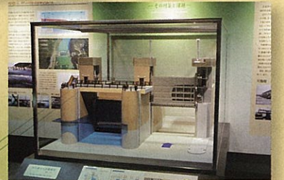
洗堰ゲート模型 洗堰に日本で初採用された「自走式油圧シリンダー」の複雑なしくみを模型で紹介합니다。
